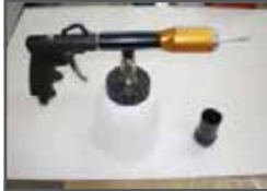
Den schwarzen Trichter losschrauben und entfernen
