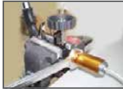
Nach Entfernung des Motorgehäuse sehen Sie die Zapfenwelle, die den Aluschlauch antreibt
