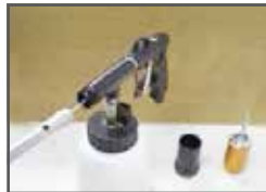
Der Rohrsteckschlüssel über den Schlauch schieben und festdrehen
