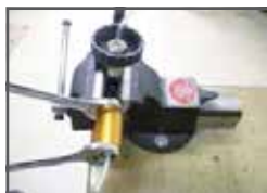
Odkręć dyszę i odkręć obudowę silnika
