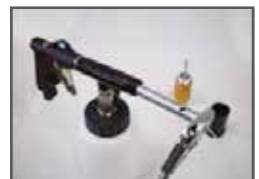
Den neuen Teflonschlauch hineinschrauben
