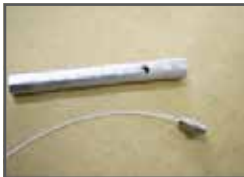
Um den Teflonschlauch zu entfernen, brauchen Sie einen 11mm Rohrsteckschlüssel
