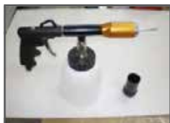
Odkręć dyszę i wyjmij ją
