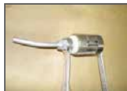
Skontroluj silnik kluczami 11 mm i 7 mm w celu poluzowania rury aluminiowej
