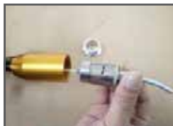
Teflonschlauch durch die Welle schieben. Falls nötig den Aluschlauch etwas drehen, um den Durchgang des Schlauchs zu vereinfachen
