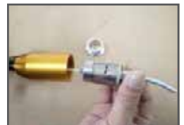
Etwas Teflon oder Loctite aufbringen und das Motorgehäuse wieder festdrehen. Zunächst den Trichter wieder festdrehen.
