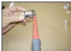
Przedmuchać obudowę silnika z obu stron za pomocą powietrza.
